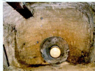
nach 8-jährigem Aufheizexperiment ist der Behälter im Salzversatz eingeschlossen
