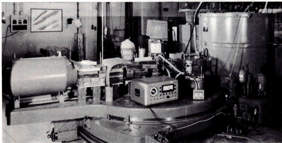
Das erste Forschungsgerät der GKSS: Ein Kristallspektrometer zur Messung von Neutronenwirkungsquerschnitten
